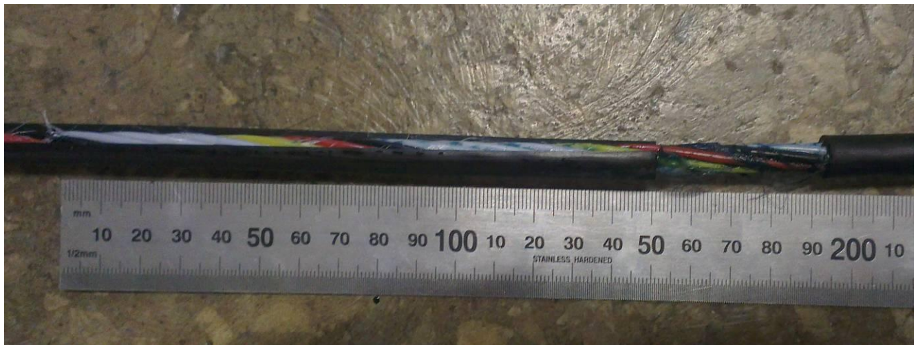
1.4. Проникновение воды в кабеле ДОТС с сухими водоблокирующими нитями (оболочка удалена после всех испытаний):
