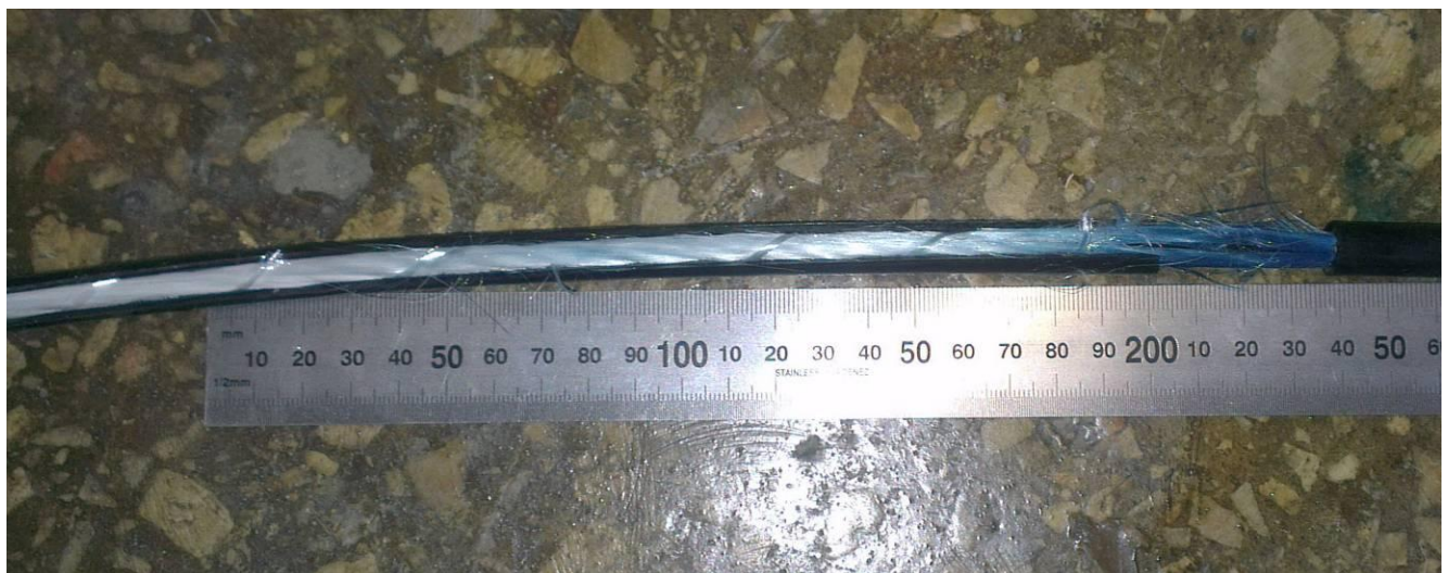
1.4. Проникновение воды в кабеле ДОТС с сухими водоблокирующими нитями (оболочка удалена после всех испытаний):
