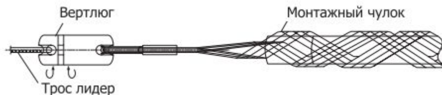
Рис.6 Схема установки монтажного чулка
